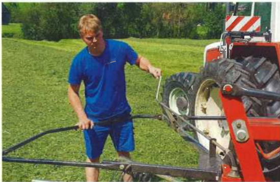
Die Arbeitstiefe wird mit einer Handkurbel eingestellt.
