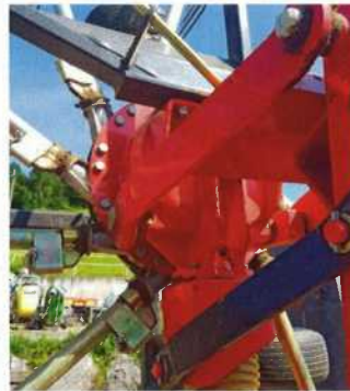
Die kardanische Kreiselaufhängung in Transportstellung.
