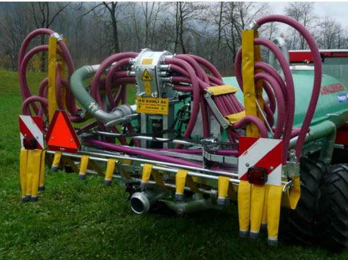
Pendillard Kohli, type Piccolo, avec tête de distribution EXA-CUT de Vogelsang, sans bourrages, avec entraînement hydraulique
