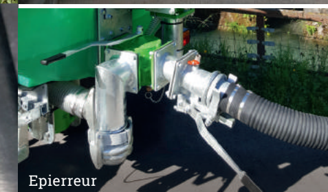
Prise de force à raccordement rapide pour pompe à lobes rotatifs Reform
